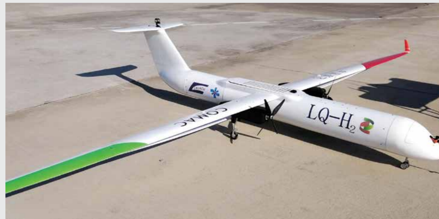
2019年3月，中国商飞“灵雀H”验证机成功试飞，国家电投研发的氢燃料电池动力系统获验证。
